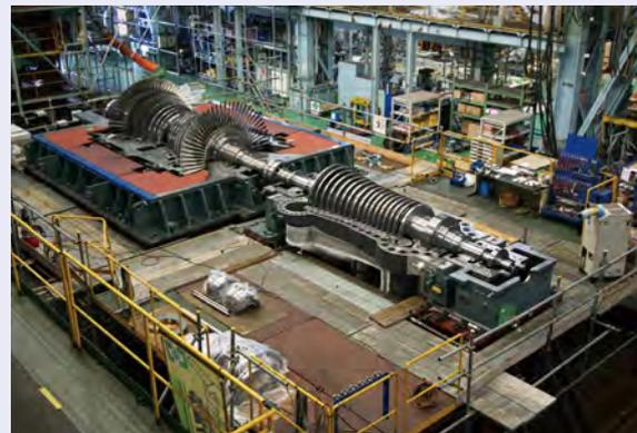
蒸気タービン150MWクラス機
