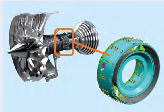
開発中の水素航空機用エンジン内水素燃焼器
