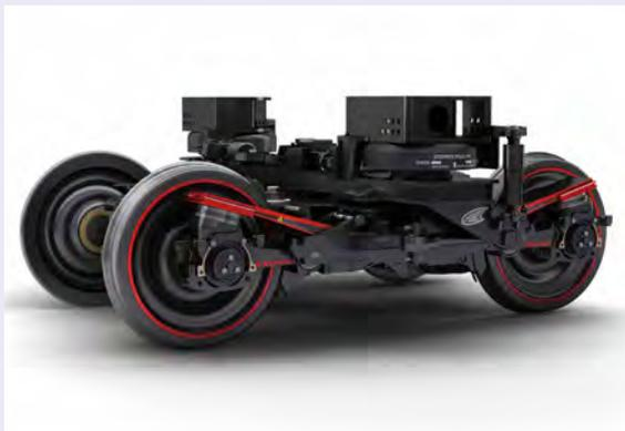
CFRPバネを採用した鉄道車両用台車「efWING」
