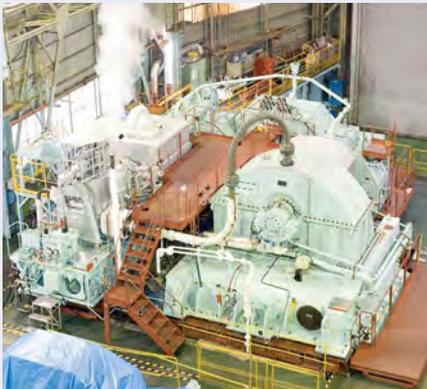
URA型再熱式蒸気タービン
