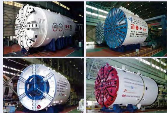
左上:英仏海峡でのトンネル掘削機、右上:東京湾アクアラインでの超大口径シールド掘削機、左下:中央環状品川線大橋での再利用型シールド機、右下:シンガポール地下鉄での泥水式シールド掘進機
