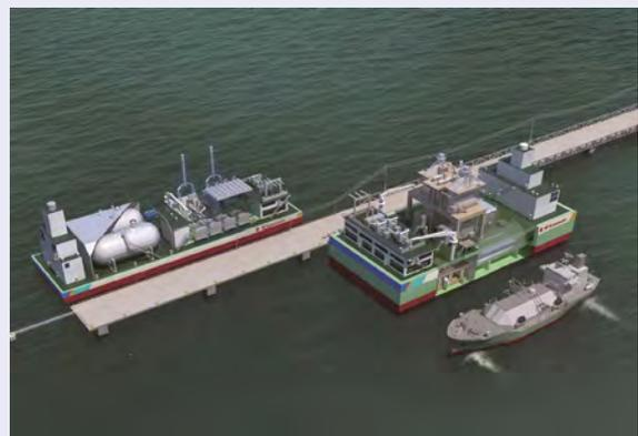
浮体式LNG発電プラントイメージ図
