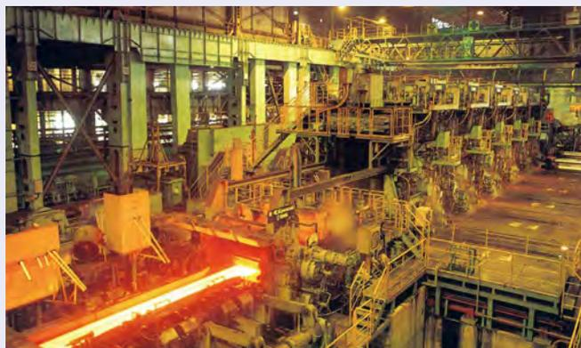
中山製鋼所船町工場の熱間圧延ライン
