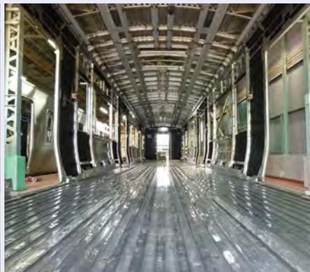
耐側面衝突性能を持つ「リング構造」
