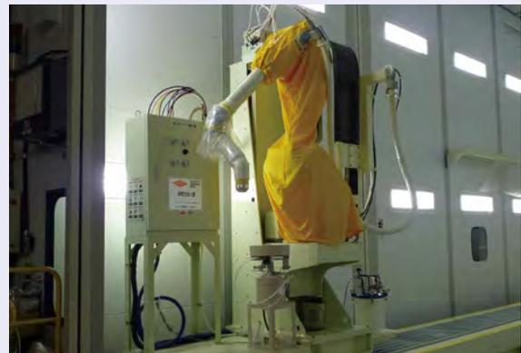
多関節式ロボットの自動塗装装置
